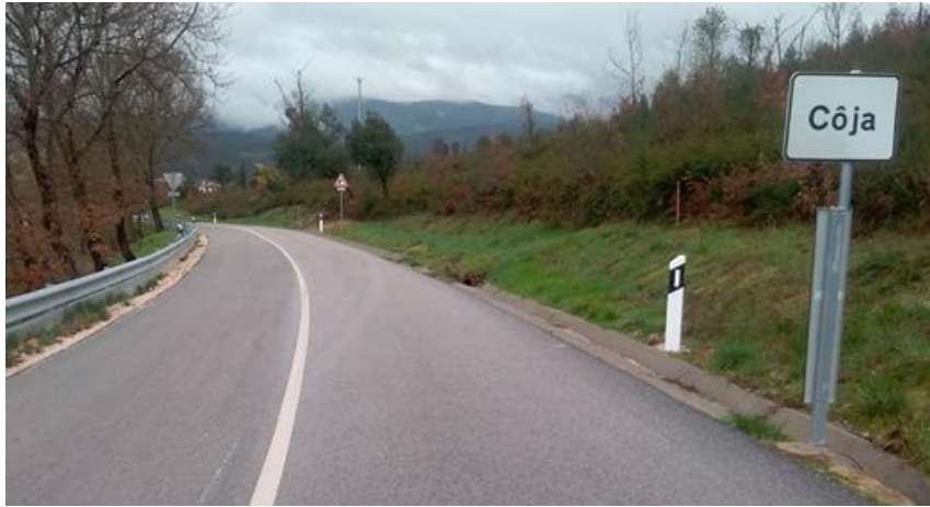
Sinais de início de localidade (N1a) colocados em zona interurbana sem qualquer edificação (recente intervenção da IP na ER 342 entre Arganil e Côja – LinkedIn 2021)
