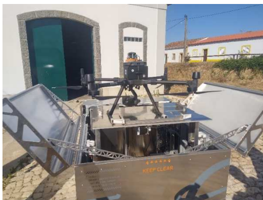
Figura 5 – Estação de Ancoragem
