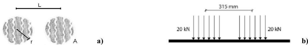
Figura 1 - a) Geometria do eixo padrão; b) Aplicação de carga no pavimento segundo o respetivo eixo padrão.
