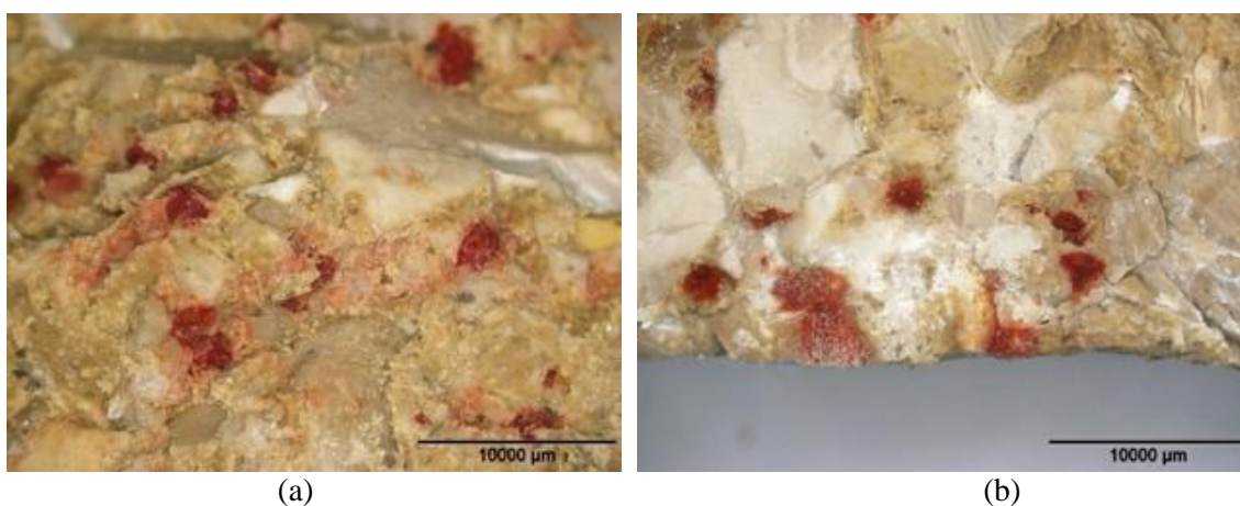
Figura 10. Pigmentação do mastique em provetes com dano [10]: (a) AC 14; (b) SMA 11.
