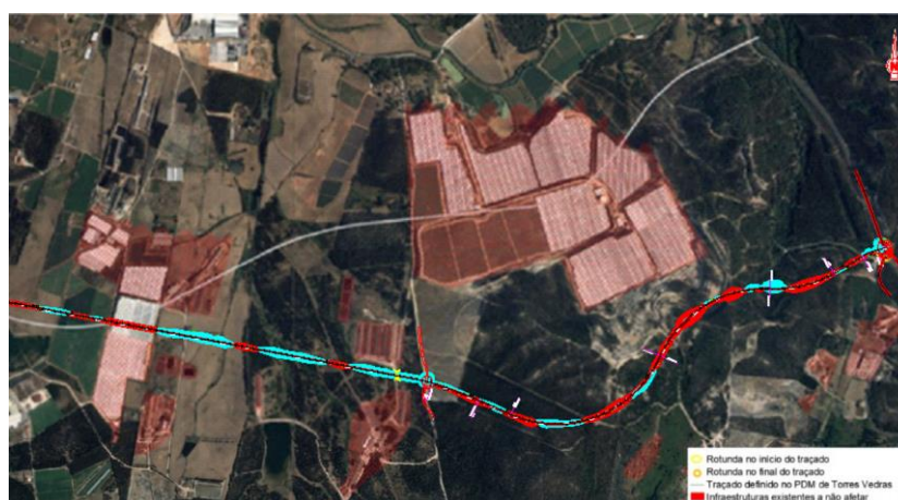
Figura 4 – Infraestruturas existentes condicionantes ao traçado.
