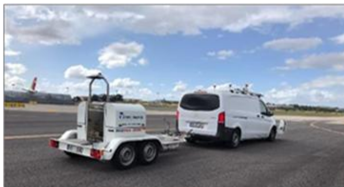
Figura 1: Defletómetro de impacto pesado (HWD).
