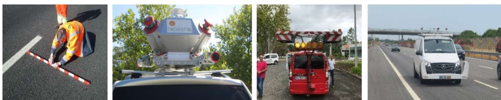
Fig. 1. Equipamentos utilizados na rede Brisa para medição das rodeiras
