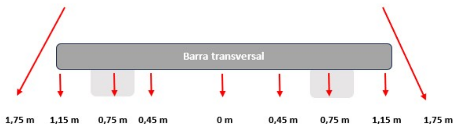
Fig.3. Posicionamento dos lasers na barra transversal
